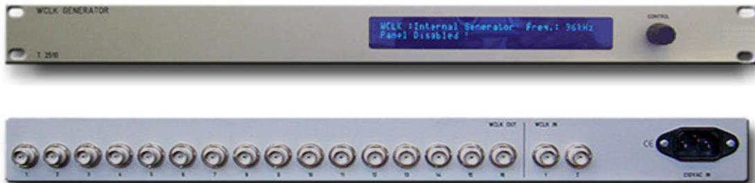
Gerät zum Generieren und Verteilen von WCLK-Signalen
